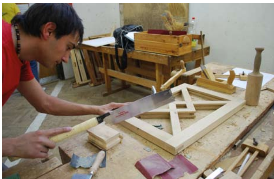
Az előválogatón a versenyzőknek egy árkolt ajtókeretet kellett elkészíteniük ferde osztókkal kiegészítve, különböző asztalosipari szerkezeti kötésekkel
